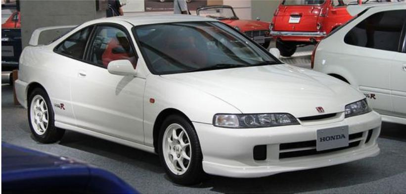
酒井的DC2属于后期款，搭载B18C1.8升VTEC引擎，原厂马力为200ps/8000rpm，最大扭矩为19.0kgm/6200rpm。并且加装涡轮增压器及中冷器,马力达300匹。
